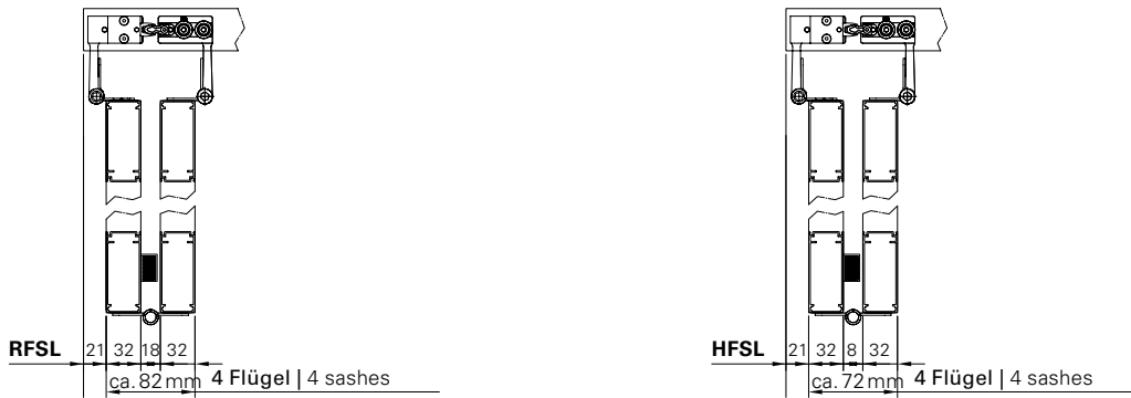
Horizontalschnitt 4-flg. Schema LL-RR, geöffnet | Horizontal section, 4-sash Diagram LL-RR, open
